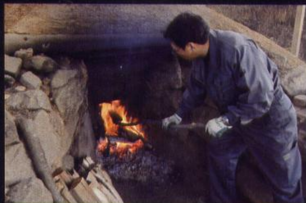
火を入れている間は、昼夜を問わず火の番をする。立ち上がる煙の色や量など微妙な変化で火加減を決める。
